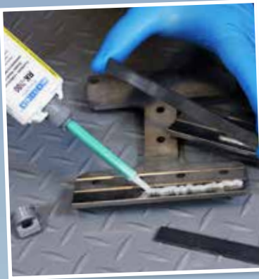
Einkleben einer Hülse in einen Tankstutzen RK-7000
